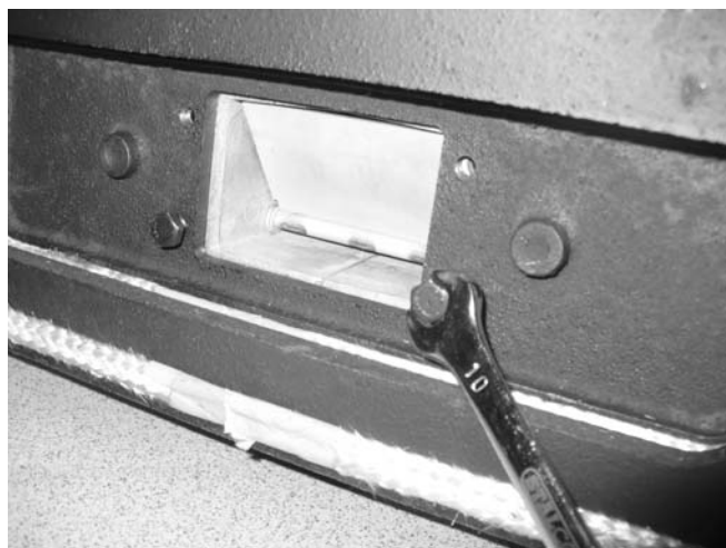
7. Dokręcić śruby tak, aby wentylator wraz z blachą osłonową był trwale zamocowany.
