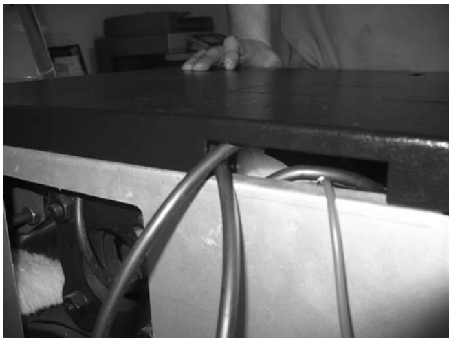
7. Pozostałe dodatkowe przewody również wypuścić otworami z tyłu obudowy.
