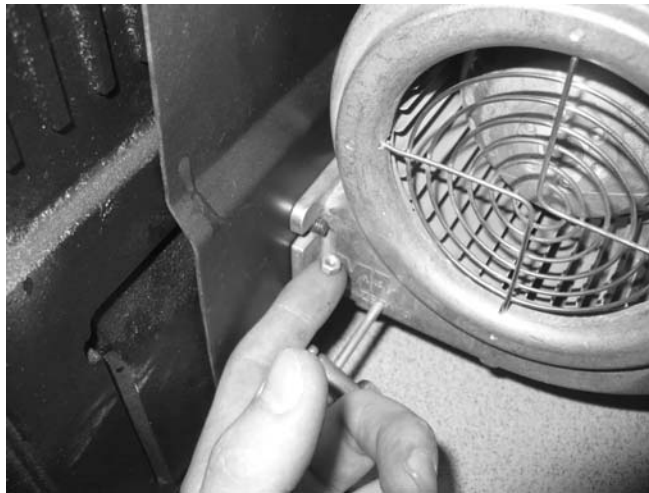
6. Na śruby założyć podkładki i nakręcić nakrętki.
