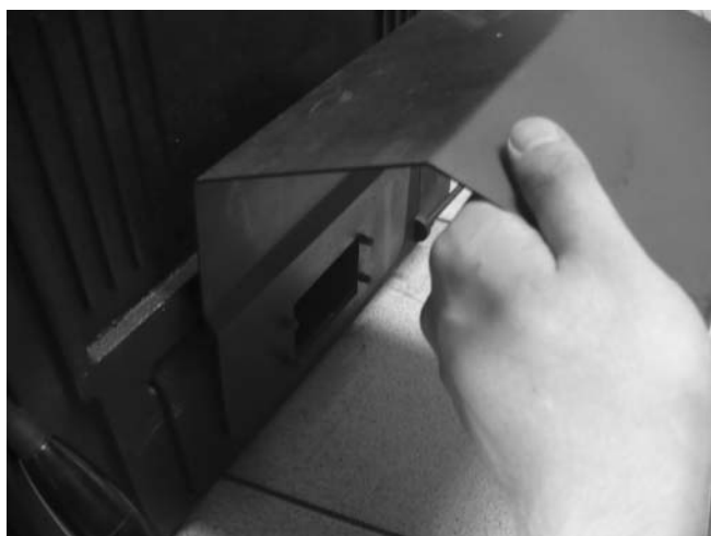
4. Na wystające śruby założyć blachę osłonową.
