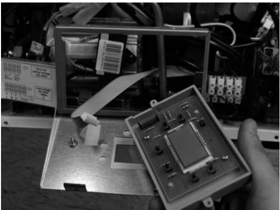
6. Odchylić klapkę panelu i odpiąć przewód łączący panel i automatykę.
